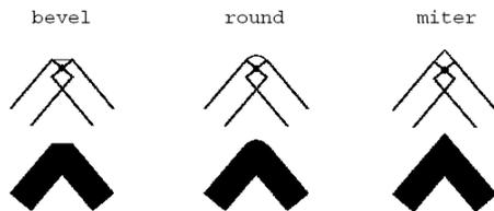
Abb. 11: Mögliche Verbindungen der Linienzwischenpunkte
