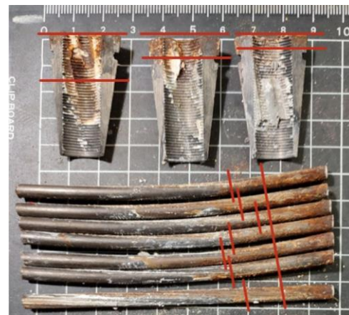
Figura 271 Detalle de "autopsia" de cuña de pretensado en zona de bloque tipo. Se observa claramente cómo .
