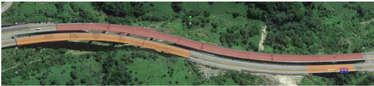
Figura 15 Planta de viaductos. Con trama roja, viaducto calzada Galicia; con trama naranja, viaductos de calzada Madrid
