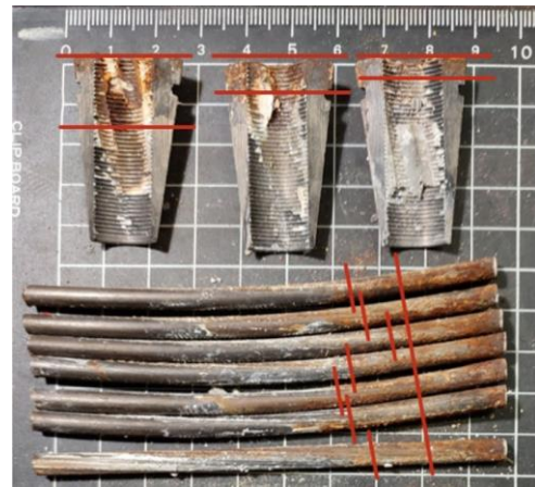
Figura 83 Detalle de "autopsia" de cuña de pretensado en zona de bloque tipo. Se observa claramente cómo la corrosión de ha entrado por el extremo trasero del cordón varios milímetros.
